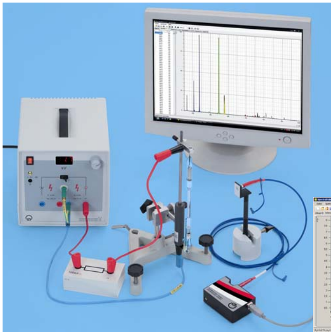
Aufnahme des Emissionsspektrums einer Hg-Spektralröhre
