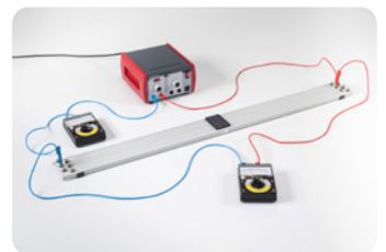
BESTÄTIGUNG DES OHMSCHEN GESETZES P3.2.2.1
