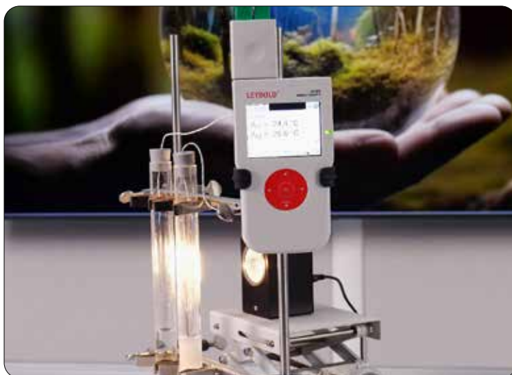
Modellversuch zur Erderwärmung durch Kohlenstoffdioxid (LB3.3.3.1C)
