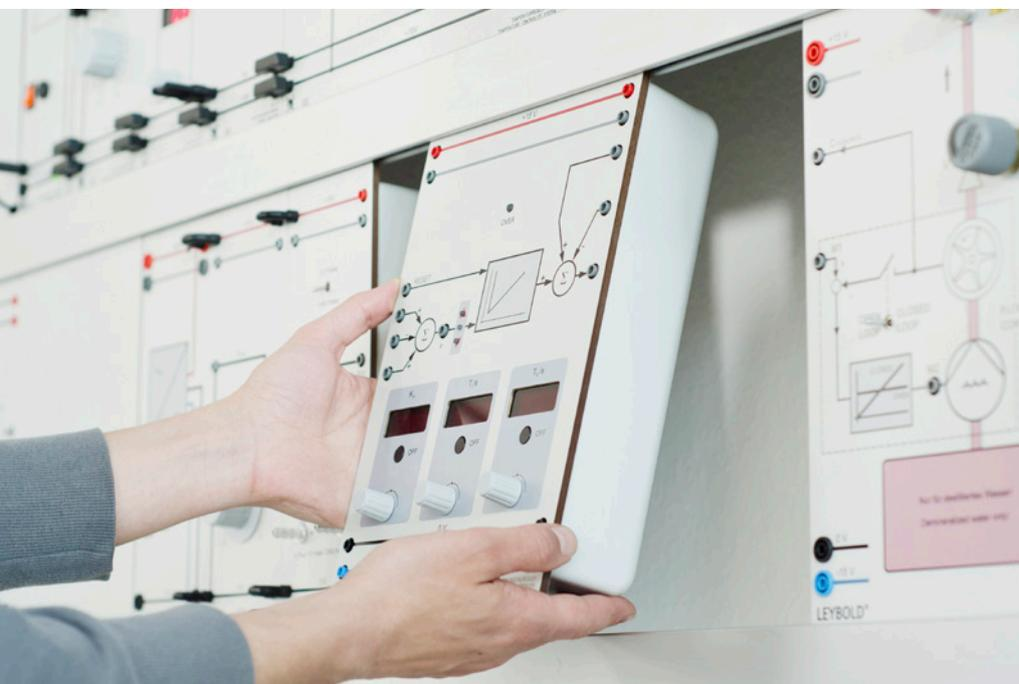
Durch das modulare Konzept können Techniklabore mit dem TPS-System schnell und einfach umgerüstet oder erweitert werden.
