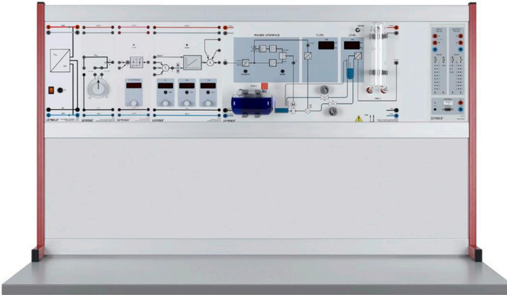
Regelung von Durchfluss & Füllstand (E6.3.1.2)
