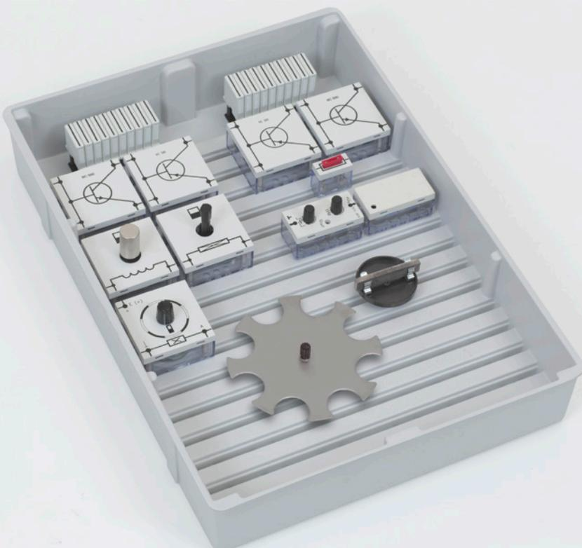
In den durchsichtigen Gehäusen der Steckelemente sind die elektrischen und elektronischen Bauteile gebrauchsfertig montiert und gegen mechanische Beschädigungen von außen geschützt. Durch das transparente Unterteil ist das Originalbauteil sichtbar.
