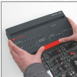
Zur Bearbeitung eines weiteren Themas wird die Master Unit schnell und einfach auf ein anderes Experimentierboard geschoben und der Kurs gestartet.
