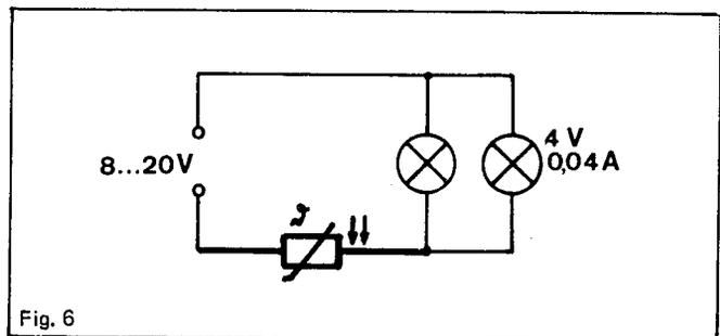
En augmentant lentement la tension par paliers d'environ 2 V on évite une surcharge des lampes due à l'échauffement de la résistance PTC. A partir d'env. 16 V les lampes deviennent même plus sombres.
