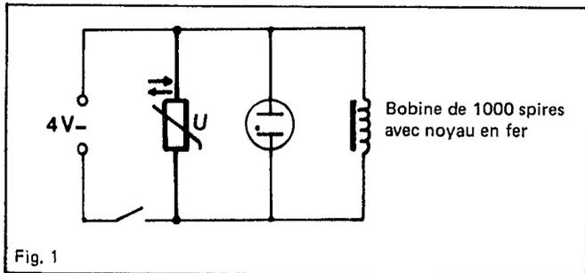
Si on enlève la résistance VDR du circuit, la lampe à effluves s'allume ce qui met en évidence les pointes de tension à la mise hors circuit.
