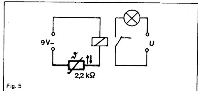
Si on chauffe avec une flamme la languette d'aluminium de la résistance NTC, le relais allume une lampe d'alarme lorsqu'une certaine température est dépassée.
