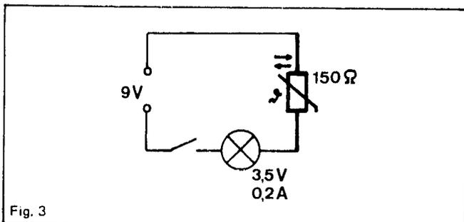
La lampe ne s'allume lentement qu'au bout d'un certain temps après avoir été allumée lorsque la résistance du thermistor a baissé par suite de l'échauffement propre.
