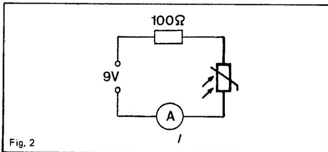
Le courant indiqué sur l'instrument de mesure est à peu près proportionnel à l'intensité lumineuse.
