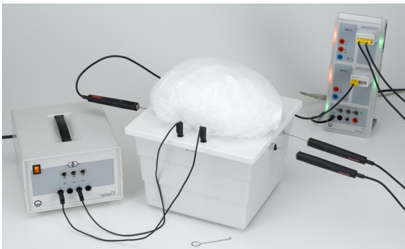
Fig. 1 Montage expérimental pour la détermination de la conductivité thermique selon le principe du capteur de flux thermique.
