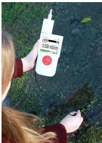
Abb. 1: Messung der Leitfähigkeit in einem Gewässer.
