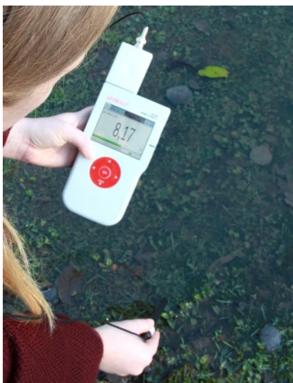
Abb. 1: Messung des pH-Wertes in einem stehenden Gewässer.
