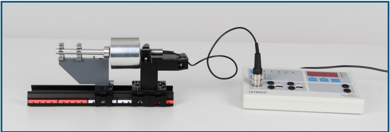
Abb. 1: Versuchsaufbau zur Abstandsmessung
