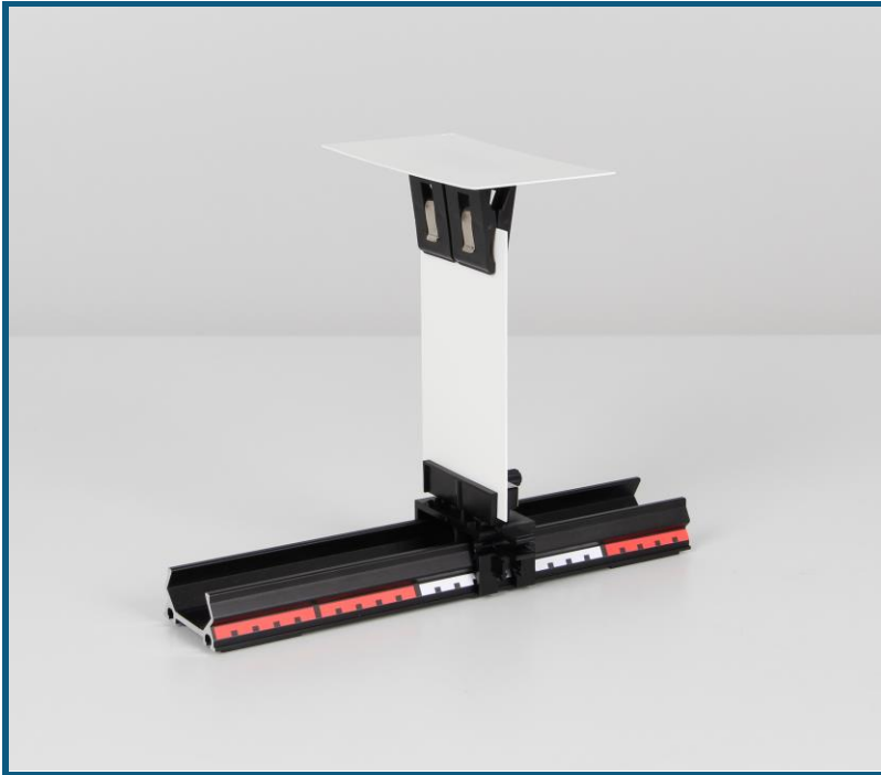
Abb. 3: Aufbau zur Exposition der Philionplatte
