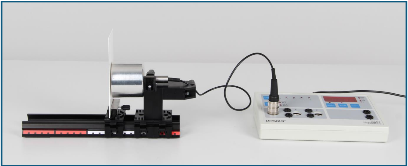
Abb. 1: Versuchsaufbau zur Untergrundmessung
