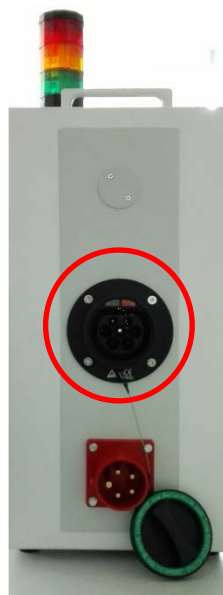
Abb. 1 - Ladesteckdose am Hochvolttrainer 739 947
