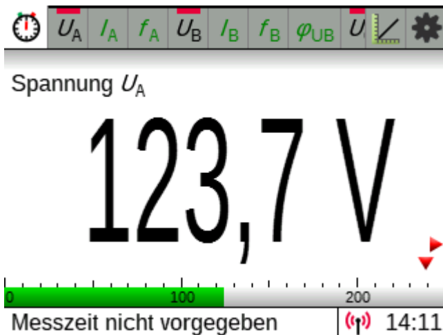
Fig. 3: Anzeige mit eingeschalteten Messgrößen.
