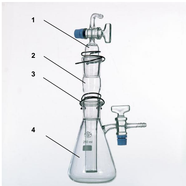
Abb. 1: Gasentwickler nach Maey, 665 647.
