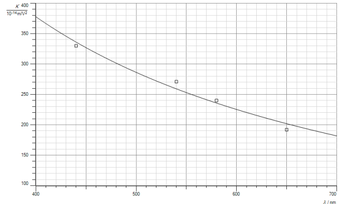
Fig. 2: Kerr-Konstante in Abhängigkeit von der Wellenlänge bei Nitrobenzol
