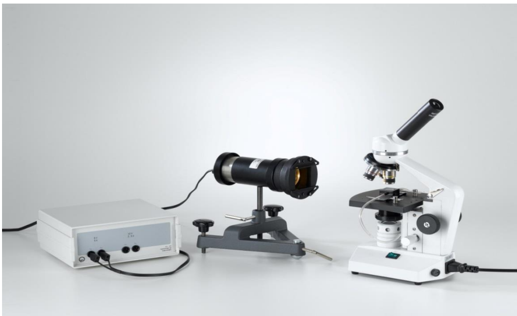
Fig. 1: Aufbau zur Beobachtung der Brownschen Molekularbewegung von Rauchpartikeln in Luft.
