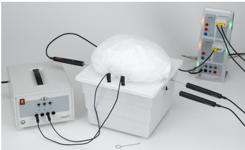
Abb. 1: Versuchsaufbau: Wärmeleitfähigkeitsbestimmung nach dem Prinzip der Wärmeflussplatte.
