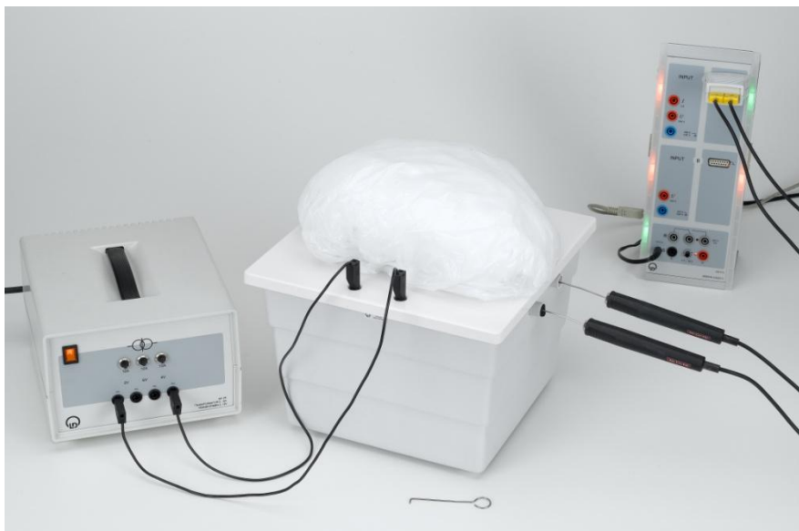
Abb. 1. Bestimmung der Wärmeleitfähigkeit einer Baustoffprobe nach dem Einplatten-Verfahren.
