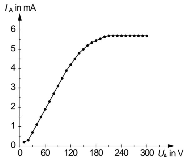
Durch den glühelektrischen Effekt treten Elektronen aus der Glühkatode der Röhre aus.
