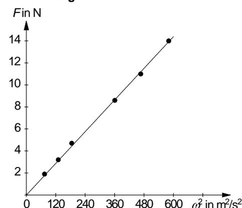
Bei konstantem Abstand eines Probekörpers vom Drehpunkt ist die wirkende Fliehkraft proportional zum Quadrat der Winkelgeschwindigkeit:  $F \sim \omega^2$ .
