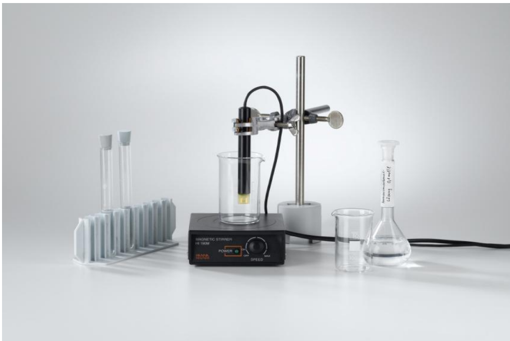
Abb. 1: Versuchsaufbau zur Leitfähigkeitsmessung.
