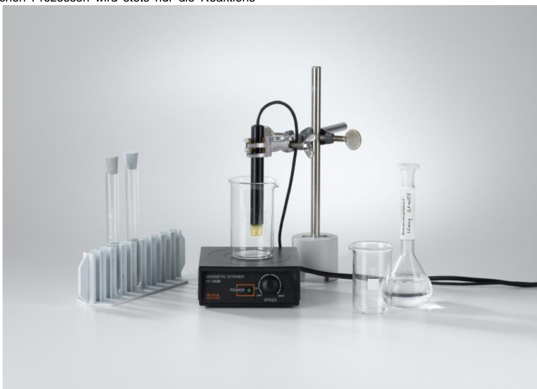
Abb. 1: Versuchsaufbau zur Leitfähigkeitsmessung.
