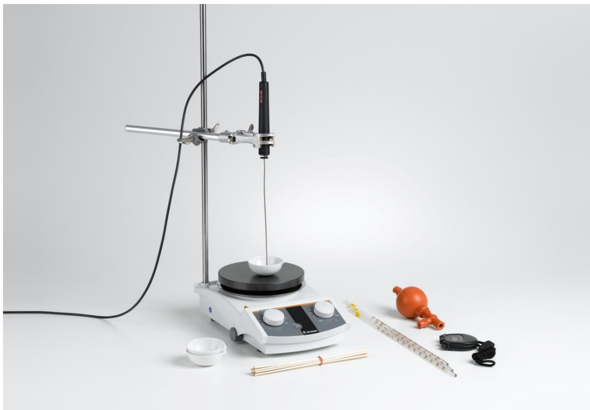
Abb. 1: Versuchsaufbau zur Analyse der Entflammbarkeit und Viskosität.
