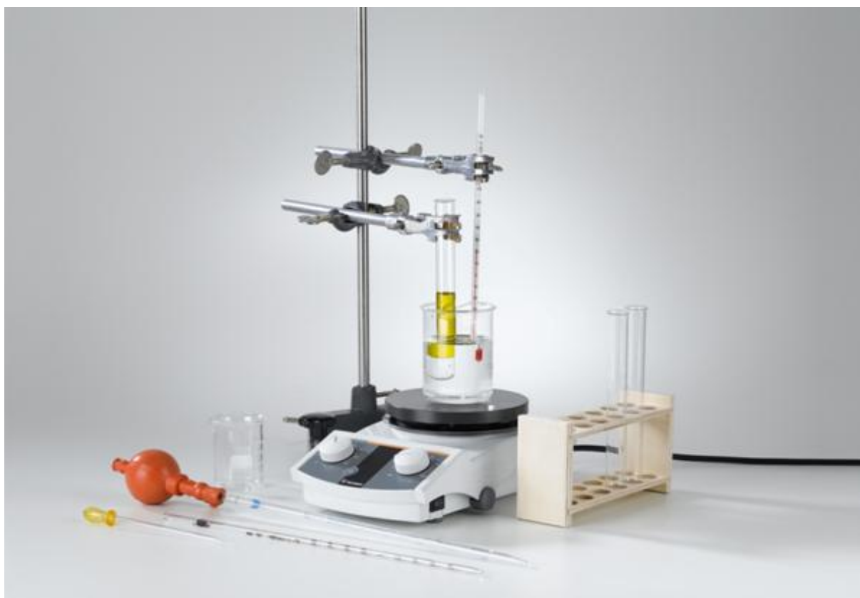
Abb. 1: Versuchsaufbau Gewinnung von Treibstoff aus Rapsöl.
