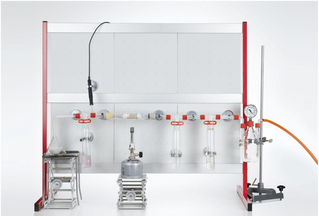
eines kostengünstigen Katalysators. Denn das ursprünglich verwendete Platin war für die Verwendung in großen Industrieanlagen zu teuer. Statt Platin verwendet man heute Vanadiumpentaoxid vermischt mit Kaliumpyrosulfat als Aktivator auf porösem SiO<sub>2</sub>.
