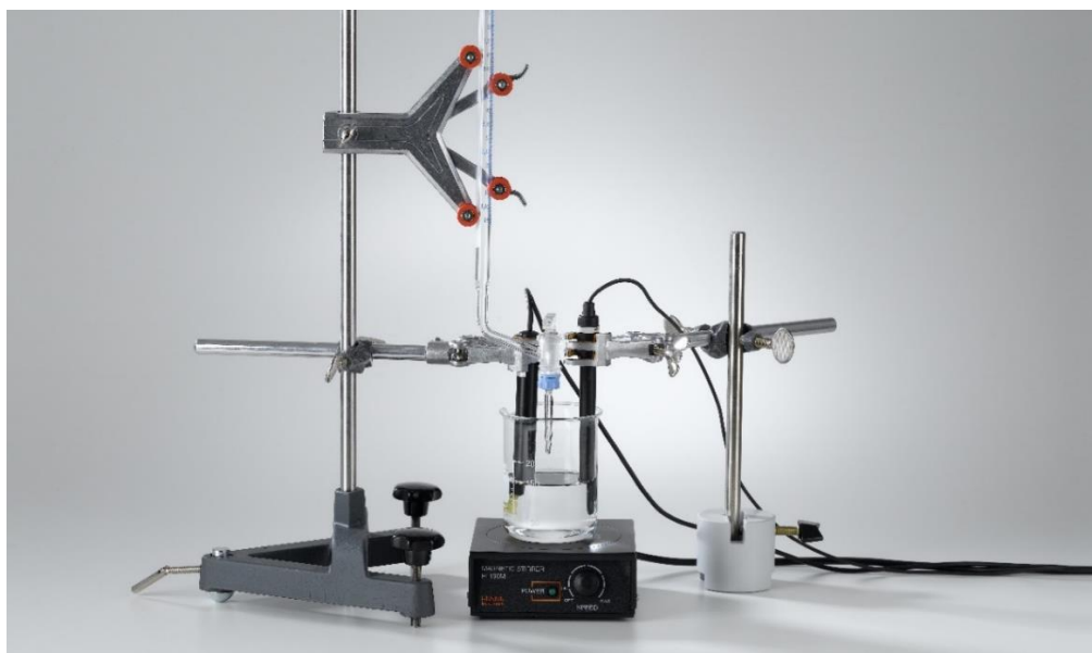
Abb. 1: Versuchsapparatur für eine konduktometrische Titration mit pH-Messung.
