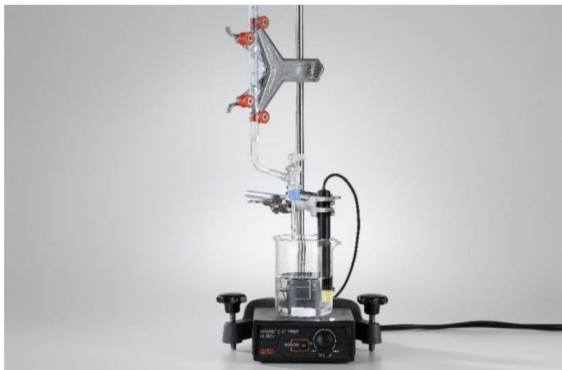
Abb. 2: Versuchsanordnung für eine konduktometrische Titration.
