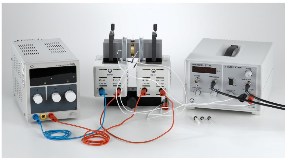
Abb. 1: Versuchsaufbau mit Versorgungsgerät (DC-Netzgerät) für die Elektromagneten (links), NMR-Apparatur (Mitte) und NMR-Betriebsgerät (rechts).
