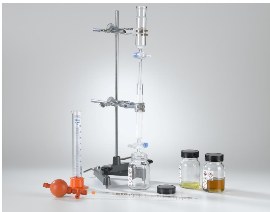
Abb. 1: Versuchsausrüstung zur Säulenchromatographie mit Erdöl
