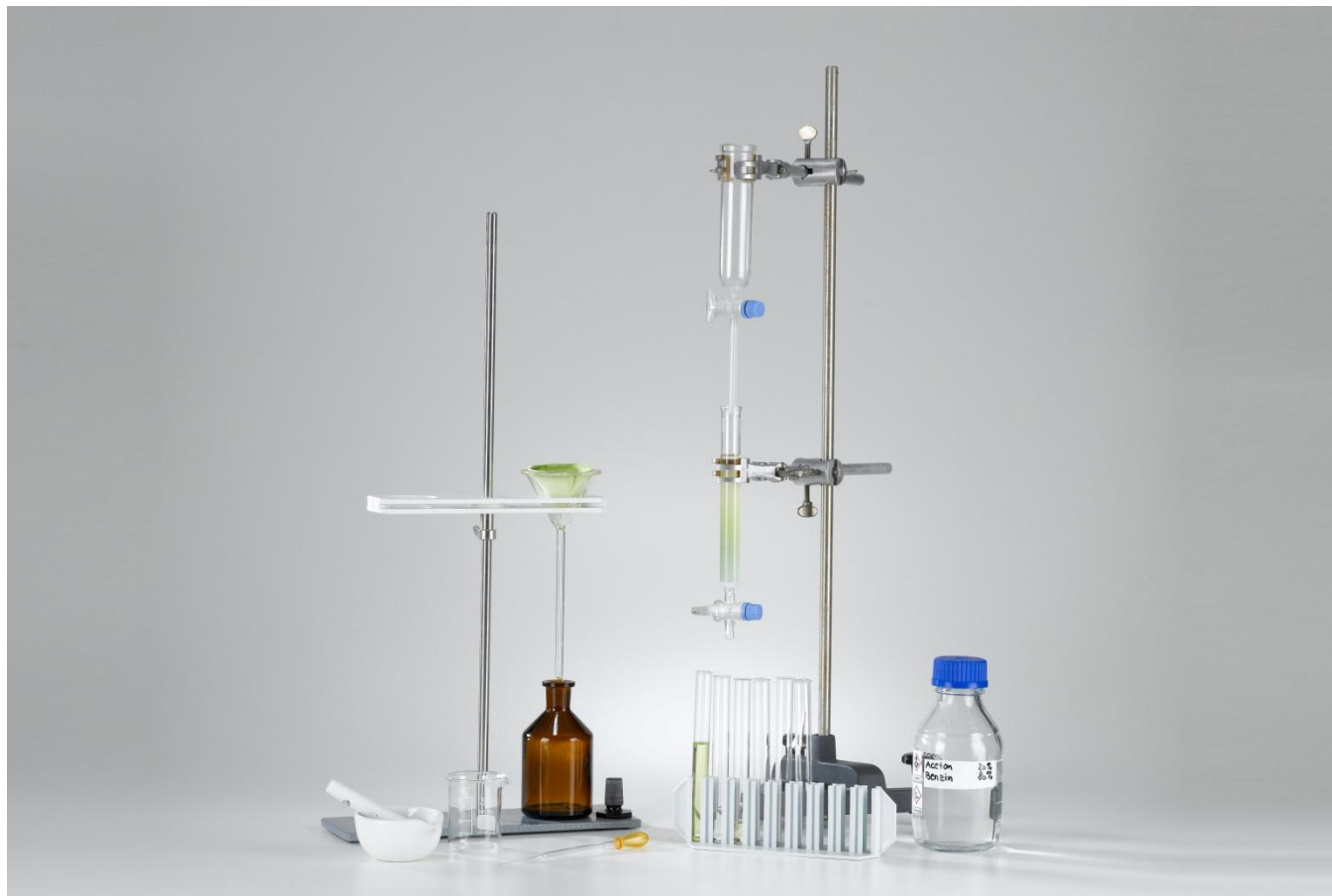
Abb. 1: Versuchsaufbau. Links: Herstellung des Blattextraktes. Rechts: Säulenchromatografie.
