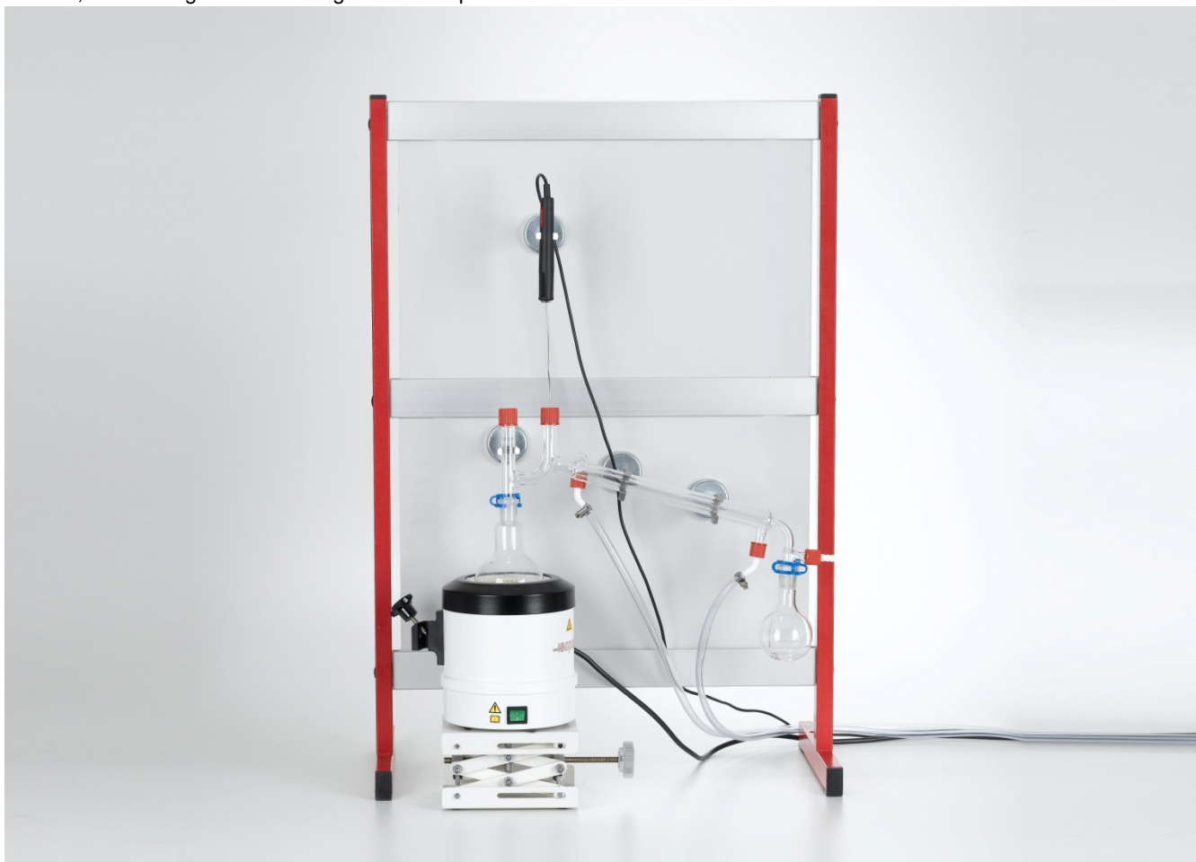
Abb. 1: Versuchsapparatur zur Destillation von Rotwein.
