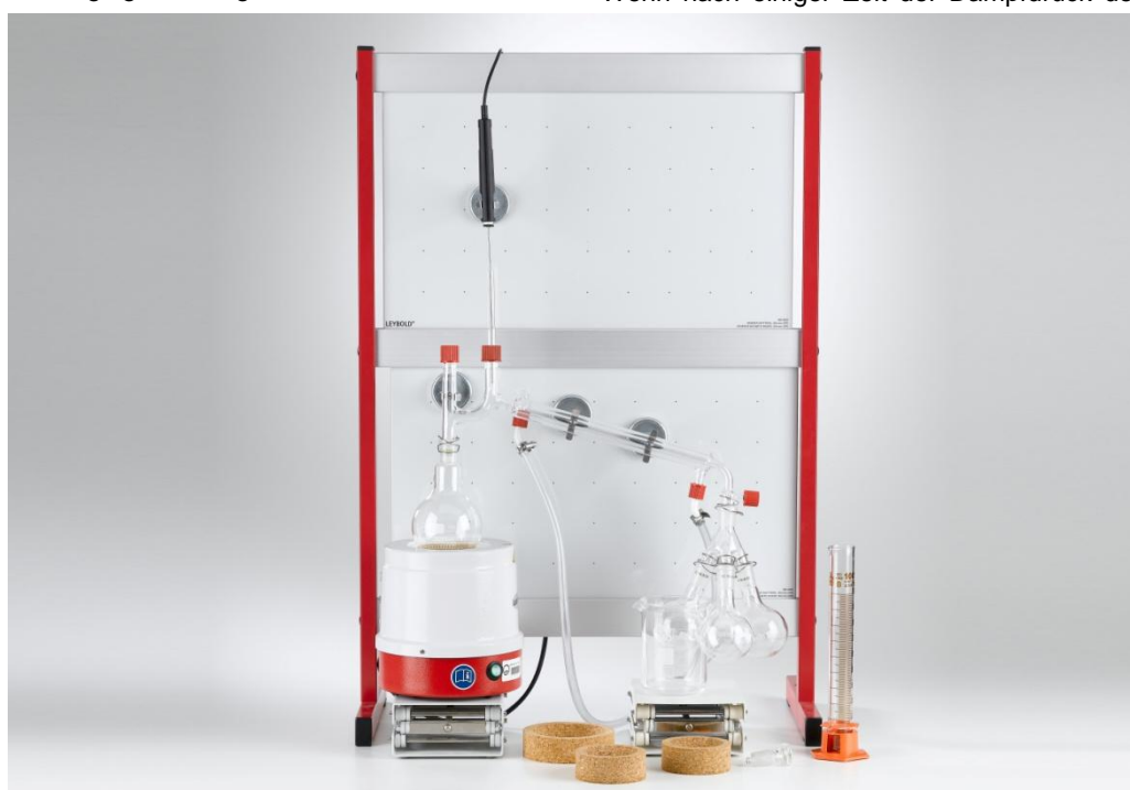
Abb. 1: Versuchsapparatur zur Destillation von Erdöl.
