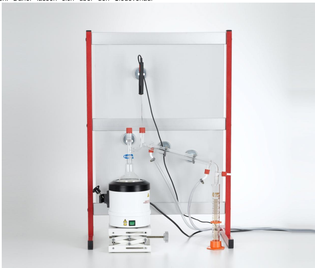
Abb. 1: Versuchsapparatur zur Siedepunktbestimmung von Benzin.
