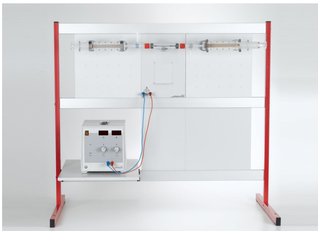
Abb. 1: Versuchsaufbau. Die Kolbenprober können auch mit je einer großen und einer kleinen Federklemme befestigt werden. Dann mit den kleinen Federklemmen das Rohr fixieren.
