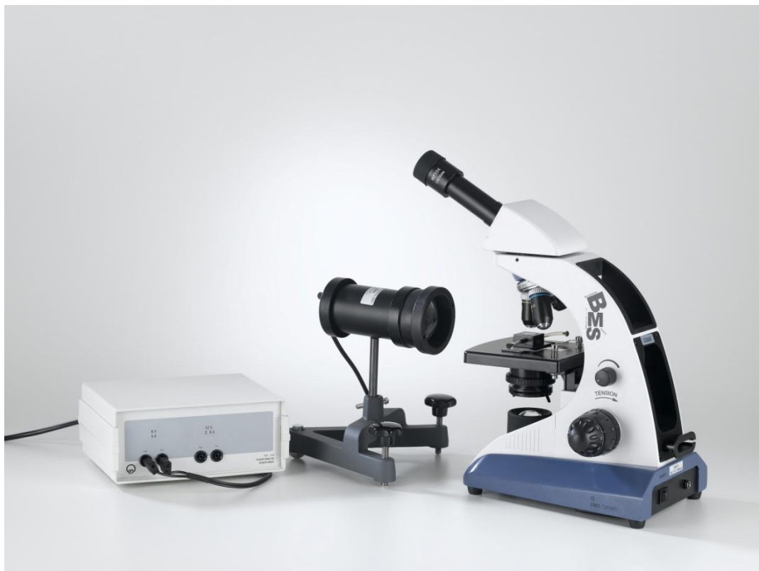
Abb. 1: Aufbau zur Beobachtung der Brownschen Molekularbewegung von Rauchpartikeln in Luft.
