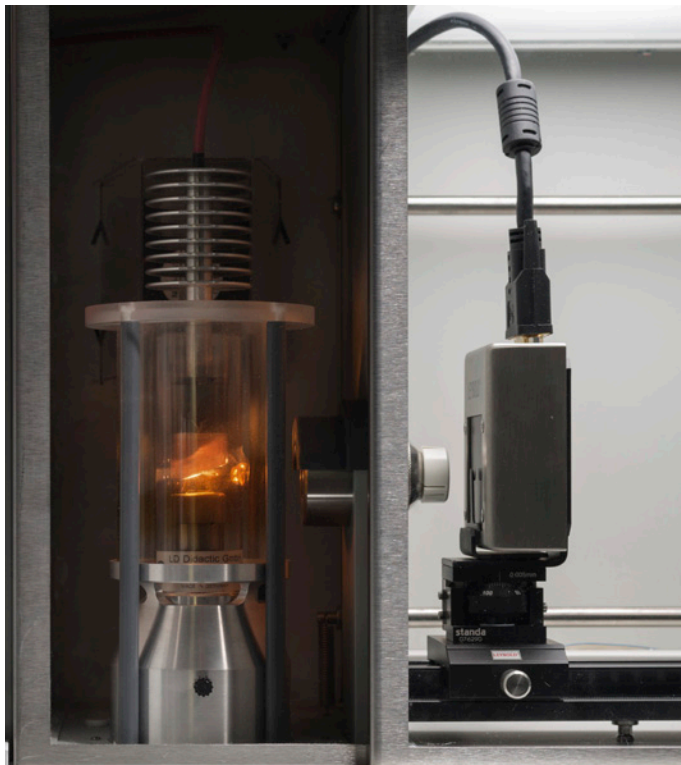
Schnelle Erstellung einer Laue-Aufnahme mit dem Röntgenbildsensor.
