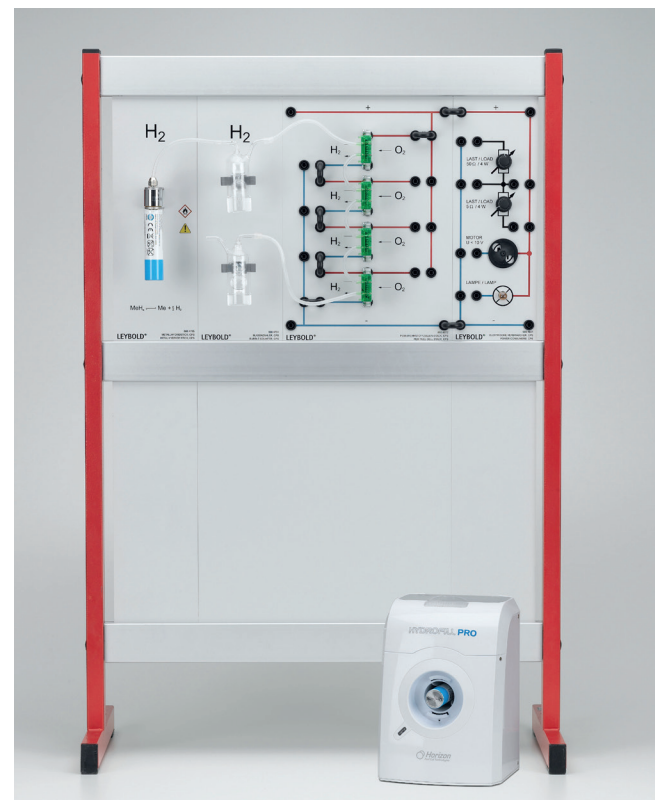
Versuchsaufbau (C4.4.7.1) zur Untersuchung von PEM-Brennstoffzellen aus dem Versuchekatalog Chemie.
