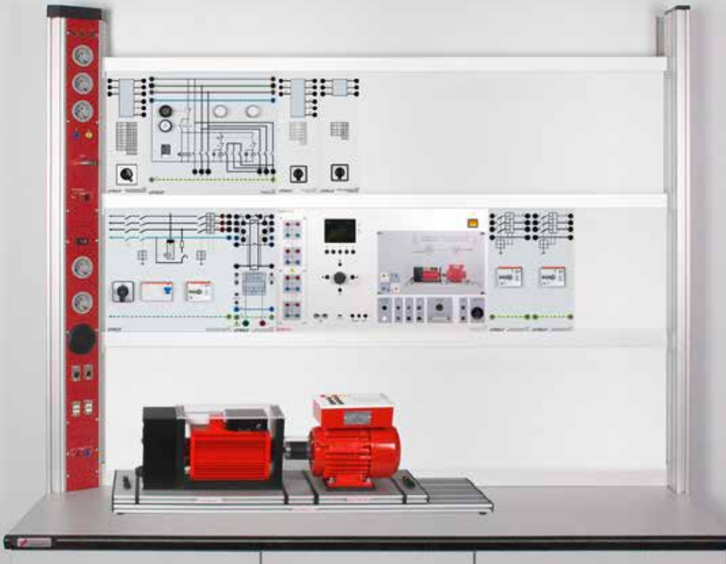
Direktanlauf und Stern-Dreieck-Anlauf eines Asynchronmotors unter Last (E2.5.4.1)
