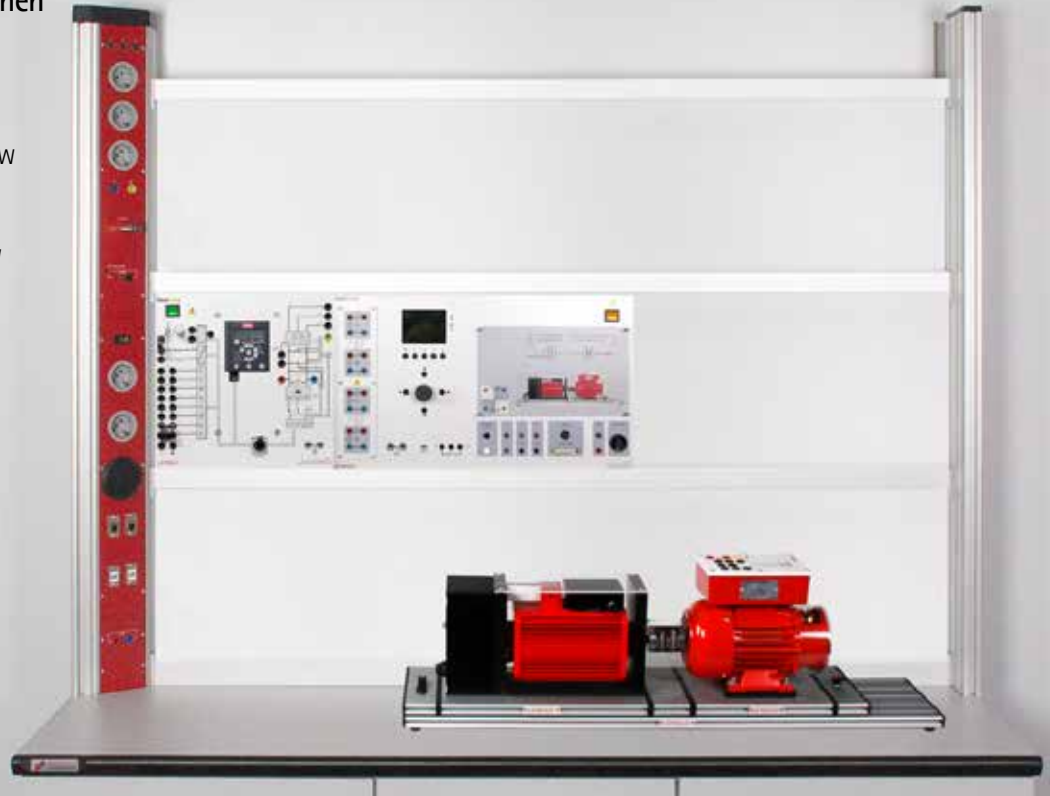
Synchronmaschine permanenterrregt mit eingebetteten Magneten, EPM, 0,3 kW (E2.2.6.1)
