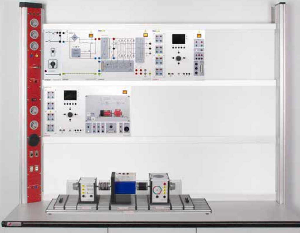
Blockkommutierte Synchronmaschine (E2.6.1.2)
