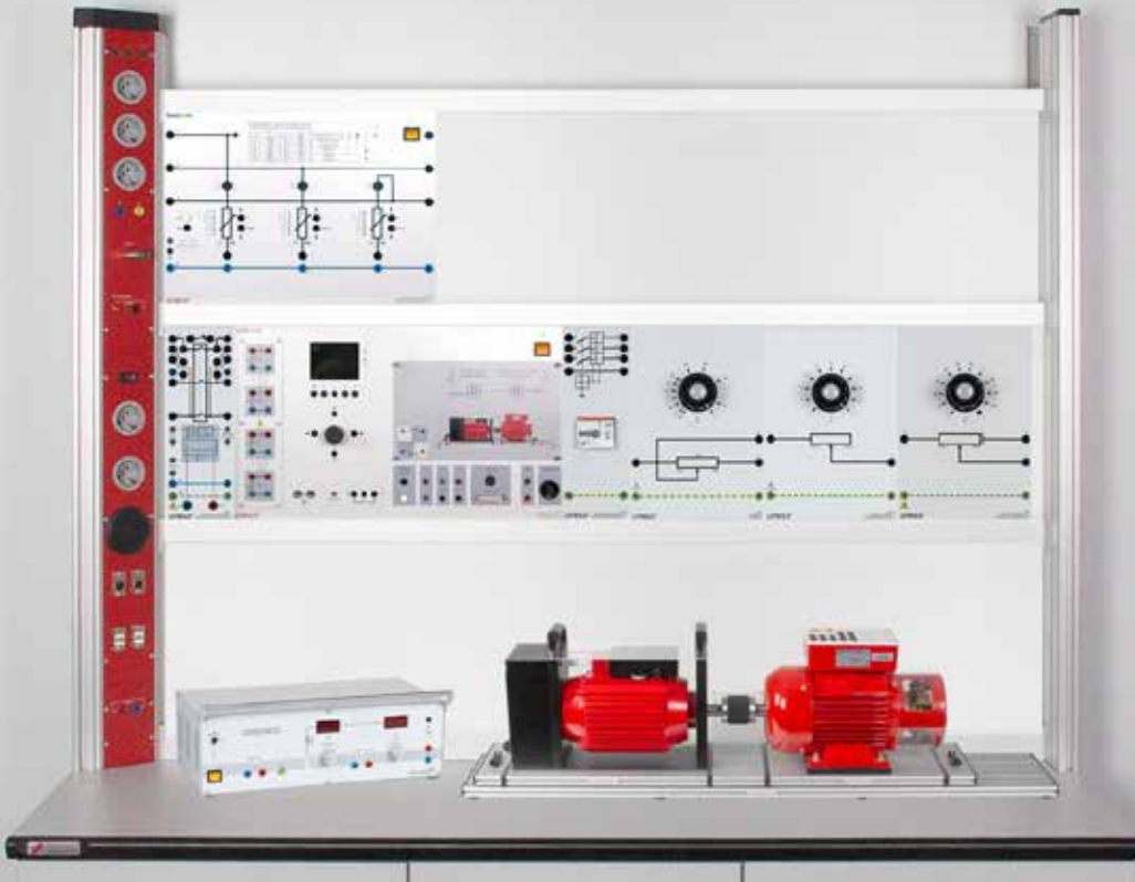
Verbundmaschine 1,0 kW (E2.3.2.1)
