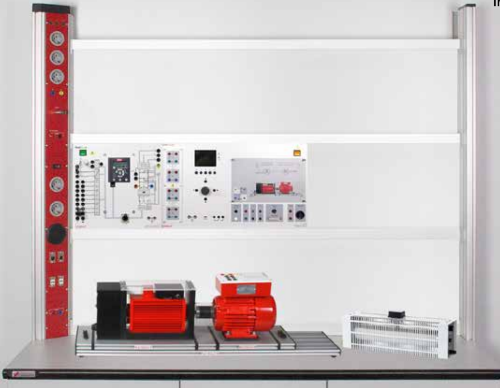
Antriebe mit Industrie-Frequenzumrichter 0,3 kW (E2.5.3.4)
