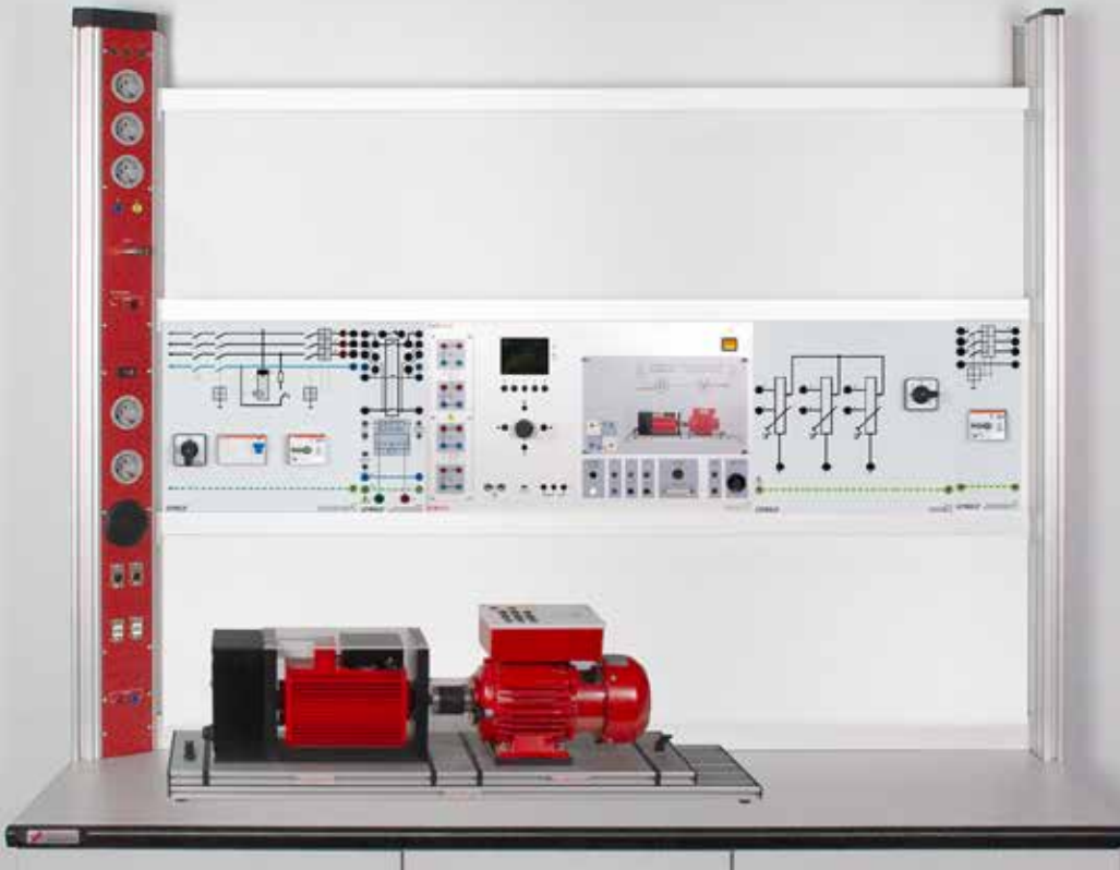
Anlaufen von großen Schwungmassen mit Schleifringläufermotor (E2.5.4.3)
