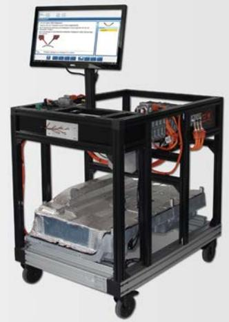
Mit dem Hochvolt-Systemtrainer ist es möglich, Isolationsfehler in den HV-Leitungen und -Komponenten zu simulieren. Dadurch kann gezielt die systematische Fehlersuche trainiert und verbessert werden. Im Gegensatz zum Fahrzeug sind alle verbauten HV-Komponenten leicht zugänglich. Im Fehlerfall liegt nur eine erkennbare HV-Spannung an, deren Strombelastbarkeit sehr gering ist.
