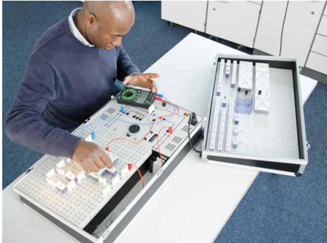
Kompaktausrüstung Grundlagen der Kfz-Elektrik/Elektronik (A1.1.1.3)
